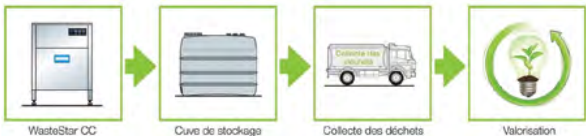
Illustration 42 : Principe général du système WasteStar (illustration tirée du « Livre blanc des déchets de restauration »)
