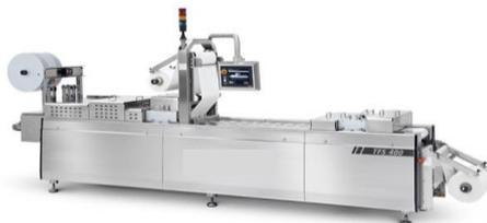
Parmi ces moyens, on trouve la mise sous atmosphère modifiée ou la mise sous vide : ils consistent à conditionner l'aliment dans un emballage contenant un mélange de gaz inertes naturels, ou en faisant le vide, ce qui ralentit considérablement l'altération du produit et prolonge sa durée de conservation.
