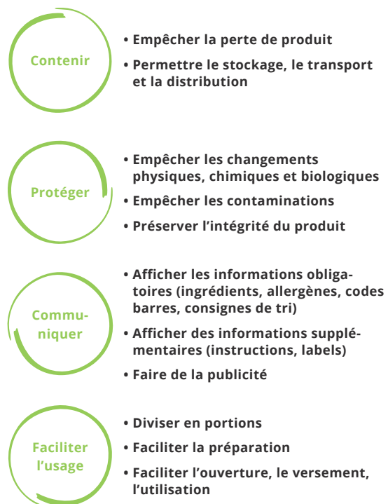
Figure 4 : Multifonctionnalité de l'emballage alimentaire. Il doit contenir, communiquer, protéger et faciliter l'usage du produit. Adapté de Wohner et al [22]
